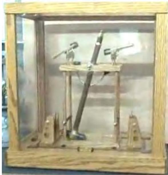
Was darauf hindeutet, das Schwingen deckt eine ziemlich kurze Strecke. Angebracht nahe dem oberen Ende des Pendels, gibt es zwei schwenkbaren Armen, die ganz wie Mikrofonen aussehen, wegen mit großen Magneten montiert auf ihren innersten Enden:
