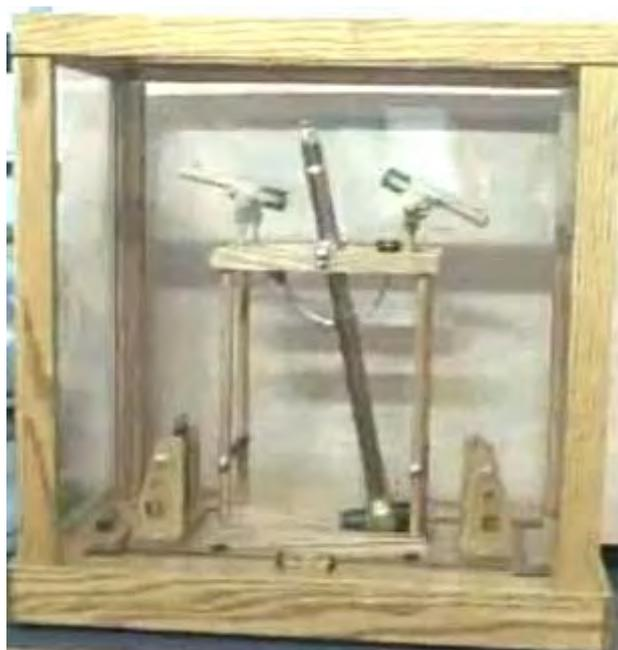
Das Pendel selbst sieht eher wie ein Vorschlaghammer aufgrund seiner starren Welle und den zusätzlichen Magneten auf das Gewicht montiert. Das obige Bild zeigt das Pendel am Ende der es Schaukel auf der rechten Seite und dem Bild unten, in seiner extremen linken Schwenkposition:
